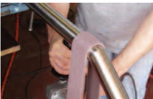
*Abschließende Angleichung mittels eines handgeführten Bandschleifers; die Kante bleibt erhalten, ohne als Schweißnaht erkennbar zu sein.*
