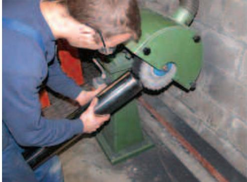
Nach dem anfänglichen Grobschliff wird mit zunehmend geringeren Korngrößen feingeschliffen. Das Schwabbeln auf einer stationären Maschine schließt die Oberflächenbehandlung ab. Nur bei einwandfreier Vorbehandlung ergibt das Schwabbeln den gewünschten Glanzeffekt.
