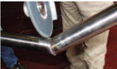
*Bearbeitung der Innenseite mit einem Winkelschleifer*
