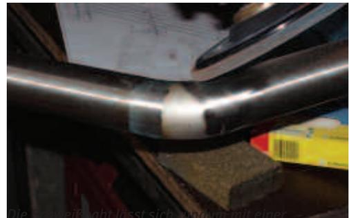
*Die Schweißnaht löst sich ab und wird mit einer Fächerscheibe bearbeitet.*
