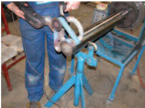
Die Rundnaht wird zunächst im Bereich des aufgesetzten Deckels vorgeschliffen.
