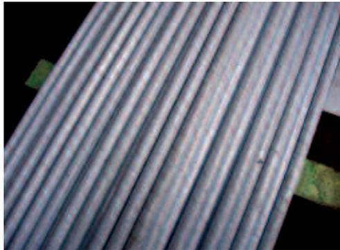
*Für die Herstellung dekorativer Konstruktionen, z.B. von Geländer- und Brüstungsanlagen, sollten möglichst geschliffene und foliengeschützte Halbfabrikate eingesetzt werden, um mechanische Beschädigung und Fremdeisenverunreinigung vorzubeugen.*
