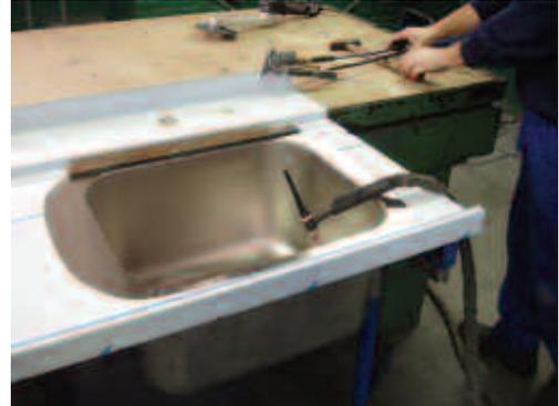
Becken und Spültisch werden sorgfältig eingepasst und mit Schweißpunkten fixiert. Anschließend wird die Schweißnaht geschlossen.
