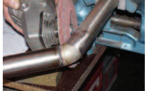
*Anschluss mit eingeschweißtem Bogen*
