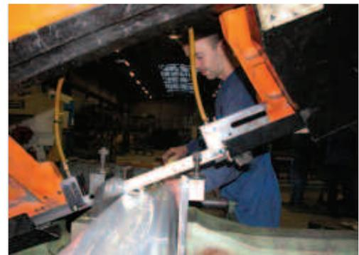
*Nichtrostende Stahlrohre können beim Handel in Standardlängen oder abgelängt bezogen werden. Auch das Schneiden unter Werkstattbedingungen ist unproblematisch.*
