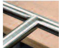
Ein stationärer Rohrausschleifer ermöglicht optimale Nahtvorbereitung für die Herstellung T-förmiger Verbindungen.
