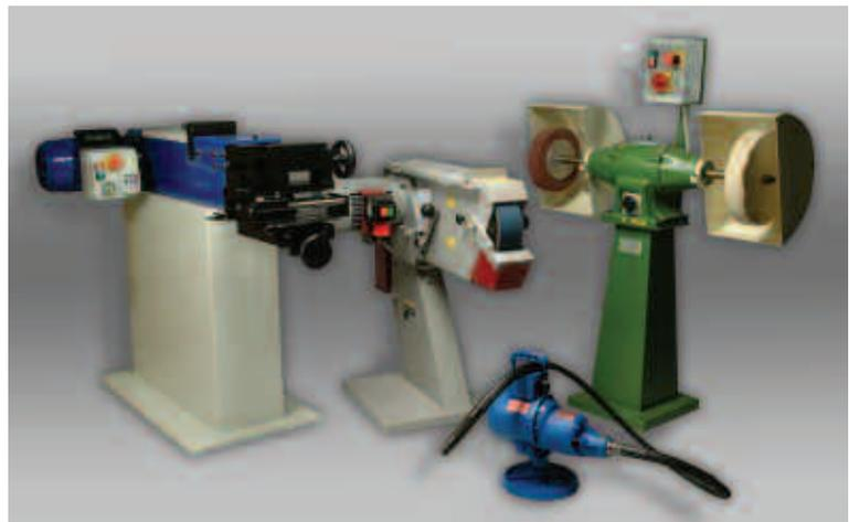
Das Gerät im Bildvordergrund ermöglicht den Einsatz unterschiedlicher, auswechselbarer Schleifvorsätze, die durch eine biegsame Welle angetrieben werden. Diese häufig auch als „Flexischleifer“ bezeichneten Geräte eignen sich für den harten Einsatz in der Serienfertigung. Da der Kopf keinen schweren Antriebsmotor enthält, werden die körperliche Belastung und das Risiko elektrischer Schläge deutlich vermindert.
