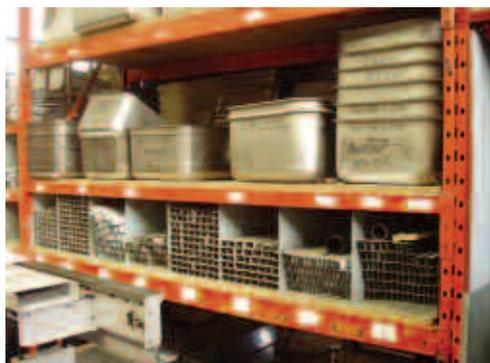
*Spültische lassen sich aus geschliffenen und foliengeschützten Edelstahltafeln herstellen. Entsprechendes Rohr- und Flachmaterial ist handelsüblich. Tiefgezogene Bauteile wie z.B. Becken lassen sich kostengünstig von Vorlieferanten beziehen, die auf das Tiefziehen spezialisiert sind.*
