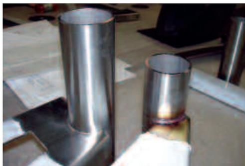
*Die beiden Stufen einer Treppenanlage zeigen die Schweißnahtbeschaffenheit vor (rechts) und nach (links) der mechanischen Oberflächenbearbeitung. Die Folie wurde zum Schutz der geschliffenen Ausgangsoberfläche weitestmöglich auf dem nichtrostenden Stahl belassen.*
