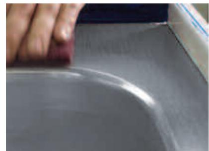
Nach dem anfänglichen Grobschliff wird die Naht mit Handschleifern und zunehmend feineren Fächerscheiben bearbeitet. Die abschließende Angleichung des Schliffbildes von Spülbecken und -tafeln erfolgt von Hand, z.B. durch sorgfältige Behandlung von Scotch-Brite™-Kissen oder ähnlichem.
