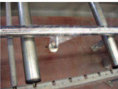
*Nach der abschließenden Bearbeitung in der Werkstatt muss die Konstruktion mit Folie geschützt werden, um Beschädigungen bei Handhabung, Lagerung und Transport zu vermeiden und Fremdeisenkontamination auszuschließen. Im nebenstehenden Bild wurde hierfür eine einfache Folienverpackung gewählt.*
