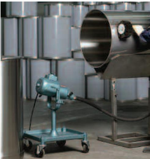
*Geräte mit flexibler Welle sind zumeist an leistungsstarke 380 V-Motoren angeschlossen. An sie lassen sich hochbelastbare und gleichzeitig leichte Köpfe ansetzen. Besonders leistungsstarke und daher schwerere Geräte sind demgegenüber oft nur eingeschränkt transportabel.*
