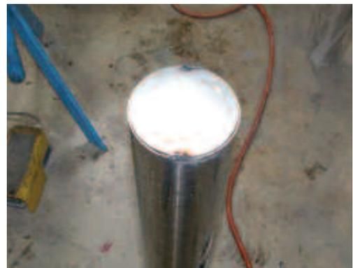
Die durchgehende Schweißnaht verleiht der Konstruktion Festigkeit und Dichtigkeit.
