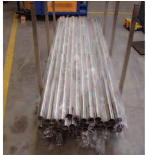
*Zur Vermeidung von Verschmutzungen und Beschädigungen sollten die ursprünglichen Folien und Schutzverpackungen so lange wie möglich auf den Teilen verbleiben. Spezielle Lagereinrichtungen, z.B. Regale oder Transportgeräte (wie der aus Edelstahl Rostfrei gefertigte Wagen zum Transport von Rohren im Bild unten rechts) ermöglichen es, Oberflächenbeschädigungen und Fremdeisenverunreinigungen vorzubeugen.*
