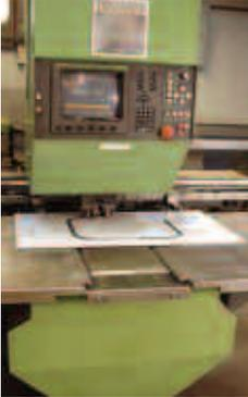
*Der Ausschnitt muss möglichst präzise und gratarm - vorzugsweise maschinell - ausgeführt werden, um das Becken passgenau einsetzen zu können. So lassen sich optimale Schweißnähte erzielen, die leicht mechanisch zu bearbeiten sind und hohen Hygieneanforderungen entsprechen.*
