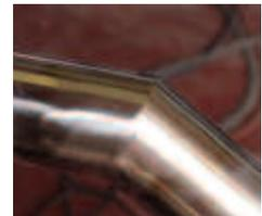
Gehrungsschnitte müssen sauber ausgeführt werden, um die gewünschte Passgenauigkeit zu erreichen und die Gefahr von Schnittverletzungen zu vermeiden. Werden Grate mit einem Bandschleifer entfernt, sind bereits wichtige Voraussetzungen für optimale Schweißnähte und die Minimierung des Nachbearbeitungsaufwands erfüllt.
