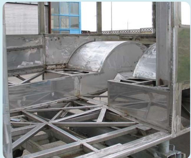
Beschweißter Konstruktionsrahmen aus 1.4003 (410).
