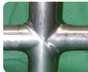
Hydrogeformtes geschweißtes Rohr (1.4003).
