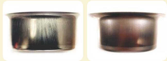
Dieser Fehler offenbart sich als eine Reihe von parallel zur Blechwalzrichtung verlaufenden Linien oder Rillen. Zugrilligkeit beschreibt das Gesamtprofil der umgeformten Oberfläche und umfasst sowohl die mikrostrukturellen Veränderungen als auch die durch die Umformung hervorgerufene Welligkeit.
