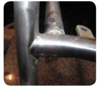
Hartlöten geschweißter Röhre aus 1.4509 (44Ti).
