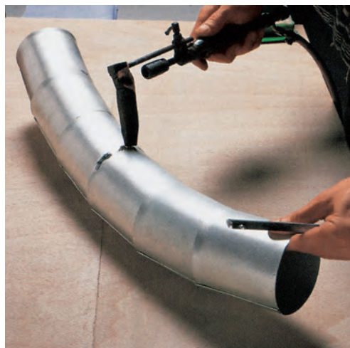
Löten am Beispiel eines Gliederbogens und einer Rinnenecke
