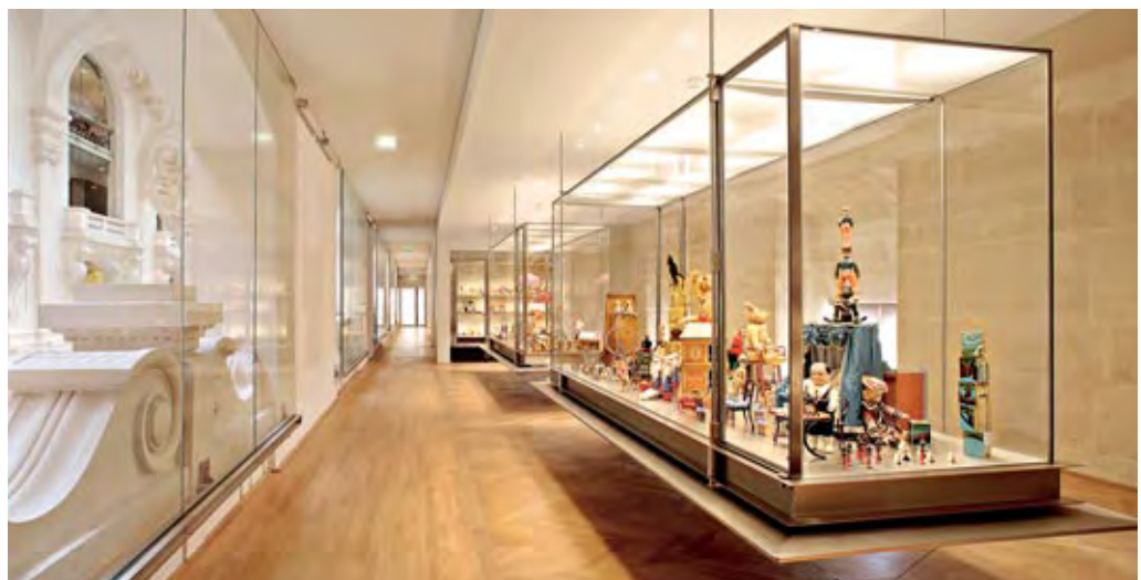
Große Glasflächen, gehalten von schlanken nichtrostenden Stahlprofilen, kennzeichnen die unterschiedlichen Ausführungen der Vitrinen.
