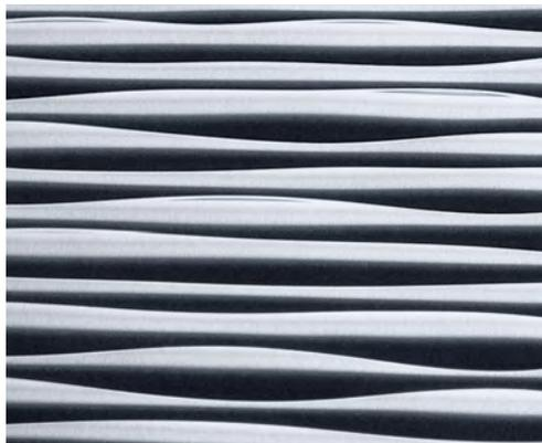
*L'idroformatura è un recente processo che allarga il ventaglio di applicazioni in architettura e nel design della lamiera stampata e del tessuto metallico, permettendo di lavorare elementi di grande formato, fino a 4 m<sup>2</sup> di superficie e 3 mm di spessore.*
