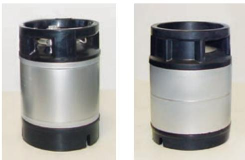
Die Umformungseigenschaften des nichtrostenden Stahls machen als Alternative auch eine zweiteilige Bauform möglich (rechts). Dabei wird das Fass aus zwei identischen tiefgezogenen Hälften zusammengesetzt. Diese Konstruktion wird dann bevorzugt, wenn Schweißnähte minimiert werden sollen. Abgesehen von den Umformungseigenschaften ist nichtrostender Stahl auch für den Kontakt mit Lebensmitteln besonders gut geeignet, da er die einschlägigen europäischen Bestimmungen sicher erfüllt.
