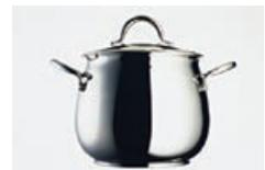
Die Handgriffe werden aus rundem oder flachem Stabstahl hergestellt und mit dem Topfkörper verschweißt. Durch Minimierung der Kontaktfläche und Auswahl eines austenitischen Stahls (der eine geringere Wärmeleitung aufweist als andere Stähle) wird Verbrennungen vorgebeugt.
