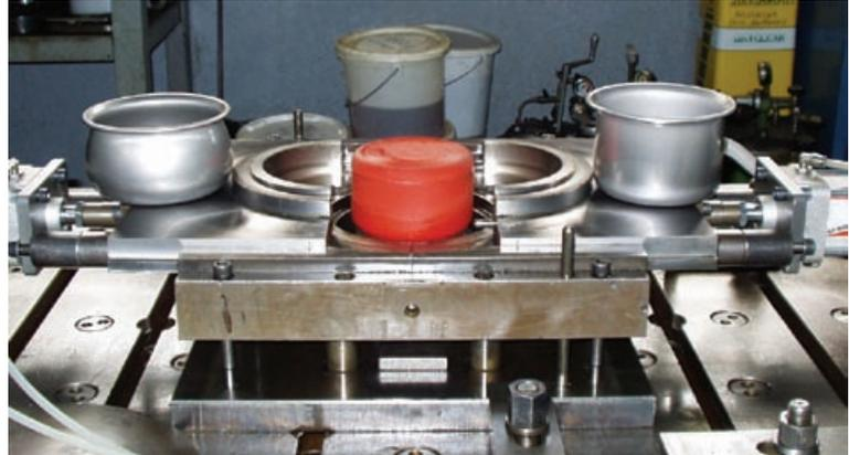
Die Umformung nichtrostender Stähle ist keineswegs auf zylindrische Formen begrenzt. Komplexere, gewölbte Formen (links) können aus einem Zylinder (rechts) mit Hilfe eines zweiteiligen metallischen Werkzeugs erzeugt werden. Dieses bestimmt die Form. Der Stempel (Mitte) besteht aus einem Paket von Hartpolymerscheiben mit jeweils unterschiedlichen Eigenschaften.
