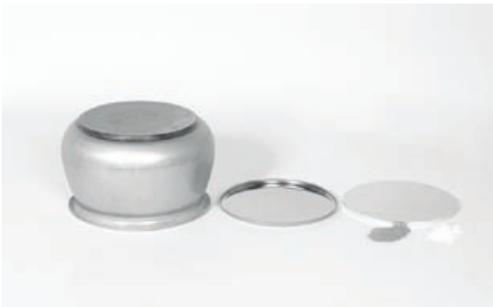
Beide werden durch eine Aluminiumronde miteinander verbunden, die für eine gleichmäßige Wärmeübertragung sorgt. Die Stanzteile werden durch Hartlöten an dem Topfkörper befestigt.
