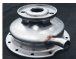
Etapes de fabrication du corps : emboutissage profond, hydroformage, perçage et retouche, pose des accessoires.
