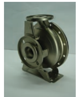
Corps en acier inoxydable par emboutissage profond
