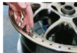
Assemblage du moyeu en étoile par la jante extérieure en acier inoxydable sur la jante intérieure.
