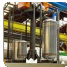
Réservoir soudé en nuance 444, Europe.
