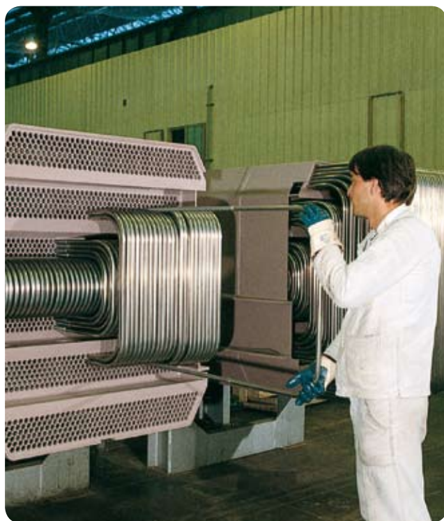
Tubes de condenseur-réchauffeur en nuance 439, Europe.
