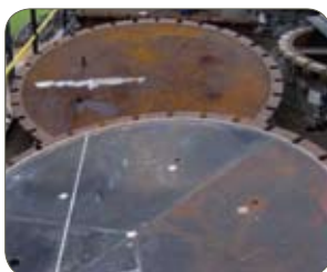
Nuance 1.4003/410, Columbus, Afrique du Sud. L'acier au carbone (en haut) comparé au ferritique (en bas) après 6 ans de service.
