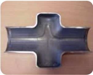
Déformation de la soudure (1.4003)
