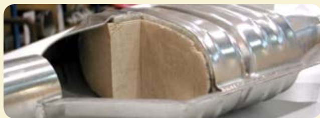
Carter de catalyseur embouti en nuance 441.
