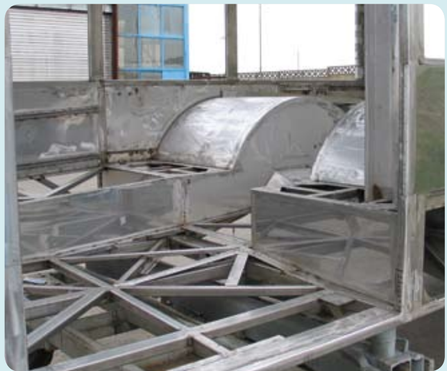
Ossature de bus soudée en nuance 1.4003.
