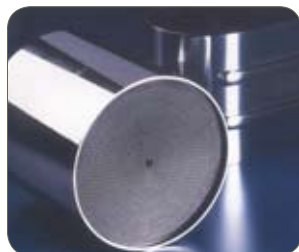
Nuance SUS430J1L, coquille de catalyseur, nid d'abeille en 20% Cr-5% Al
