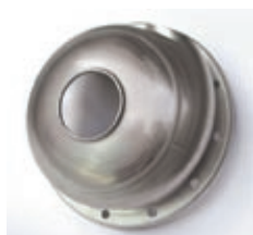
Carcassa di pompa ottenuta da un disco in acciaio inossidabile mediante imbutitura profonda. L'entrata è nella parte frontale e il liquido esce attraverso un'apertura idroformata sulla parte superiore.
