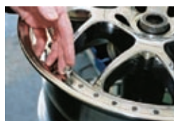
Montaggio del mozzo a stella sul cerchio interno attraverso il cerchio esterno.
