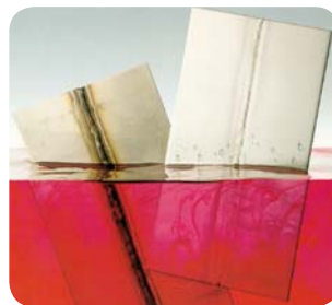
Prima e dopo il decapaggio.
