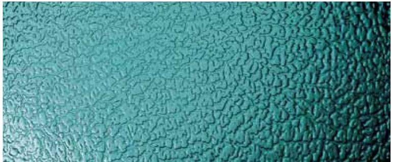
L'aspect coloré peut disparaître par abrasion. Le procédé ne devra donc pas être employé lorsque la surface risque d'être endommagée accidentellement ou délibérément, dans les espaces fortement fréquentés, par exemple, ou lorsque l'air est chargé en particules abrasives [2, 5]. La coloration superficielle sera également éliminée par un décapage chimique, l'électropolissage ou la photogravure.
