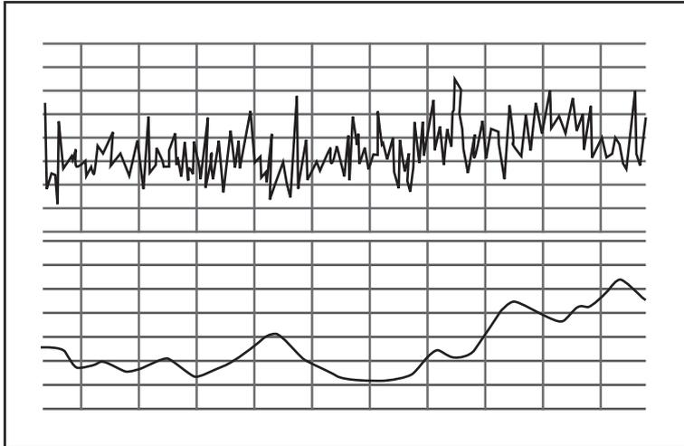
Rugosità superficiale dell'acciaio inossidabile lucidato meccanicamente; sopra: grana 400, sotto: grana 120 e successivamente elettrolucidato. Entrambe le superficie mostrano identici valori di  $R_a$ .
