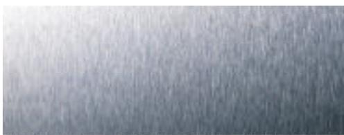
*L'aspetto delle superfici levigate dipende dal materiale e dalla granulometria dei nastri smeriglio; nella figura sopra, un esempio ottenuto con numero di grana 180, in quella sotto con 240.*
