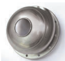
Corps de pompe à partir d'un flan embouti en acier inoxydable. L'entrée se situe à l'avant et le liquide s'échappe du corps grâce à un orifice hydroformé sur le dessus.
