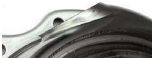
L'involucro a spirale è integrato per idroformatura all'interno della carcassa della pompa. L'apertura esterna ha una finitura accurata, per migliorare l'efficienza di esercizio.
