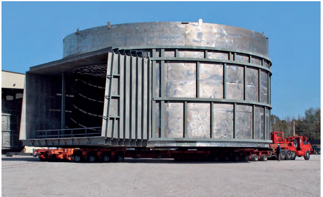
Rauchgasentschwefelungsanlage aus dem Stahl EN 1.4462 (2205); (Quelle: Aperam)
