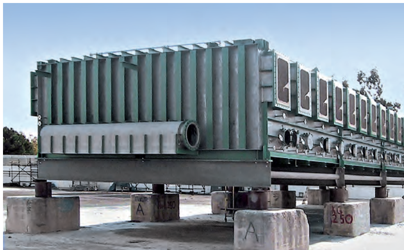
Mehrstufen-Verdampfer- Meerwasserentsalzungsanlage aus den Stählen EN 1.4462 (2205) und EN 1.4162 (UNS S32101); (Quelle: Outokumpu)
