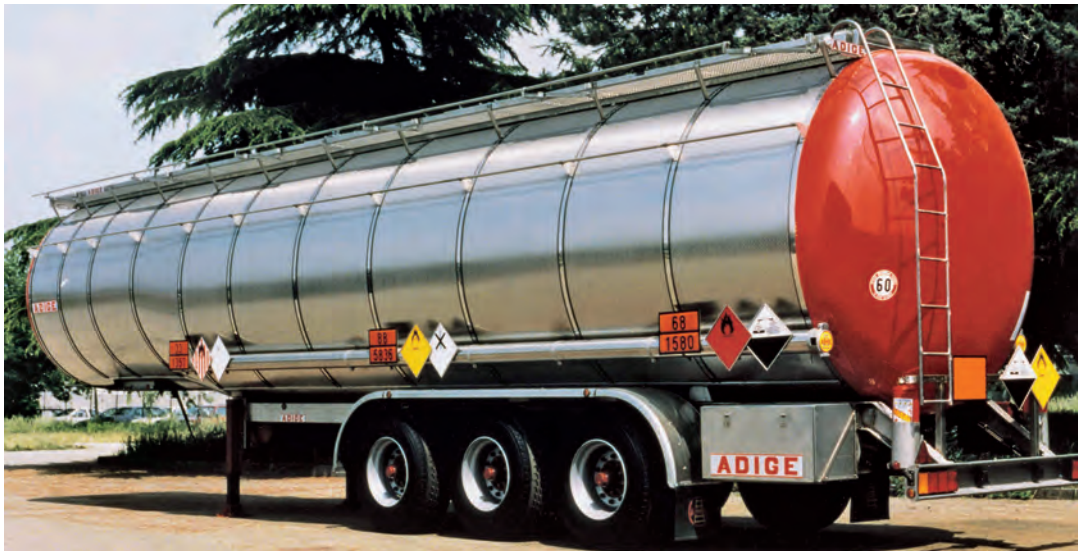
Asphalttransporter aus nichtrostendem Duplexstahl (Quelle: Outokumpu)
