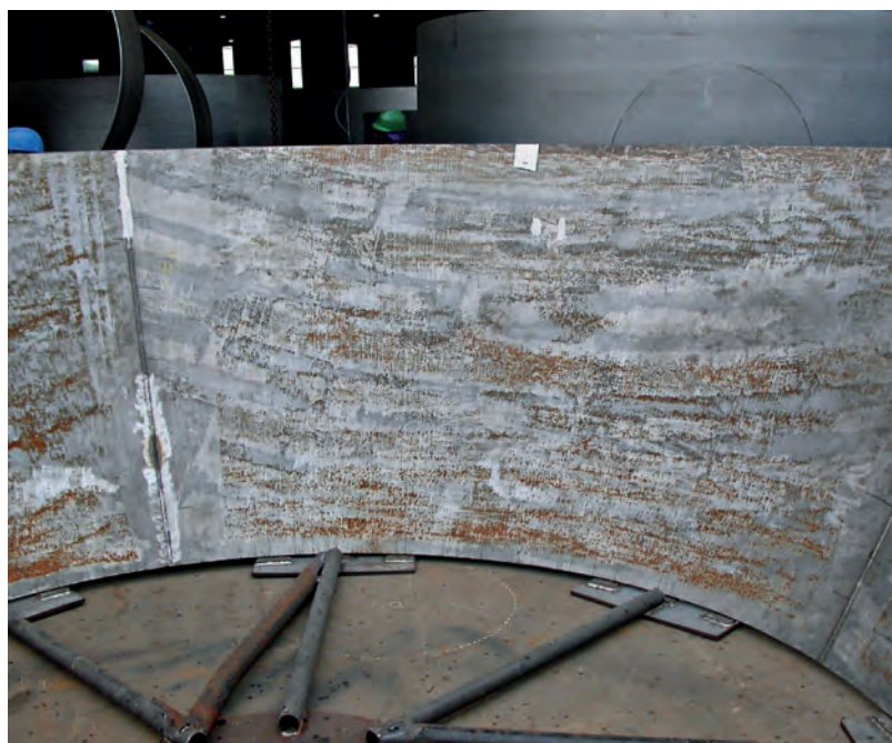
In die Oberfläche eingedrücktes Fremdeisen bei einem rollgeformten Teil aus nichtrostendem Duplexstahl EN 1.4462 (2205); (Quelle: Gary Carinci, TMR Stainless)
