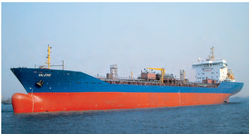
Chemikaliertanker mit Tanks aus dem Werkstoff EN 1.4462 (2205); (Quelle: Aperam)
