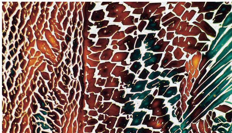
Schliffbild Schweißnaht im Duplexstahl EN 1.4462 (2205) in 500-facher Vergrößerung (Quelle: Lincoln Smitweld bv)
