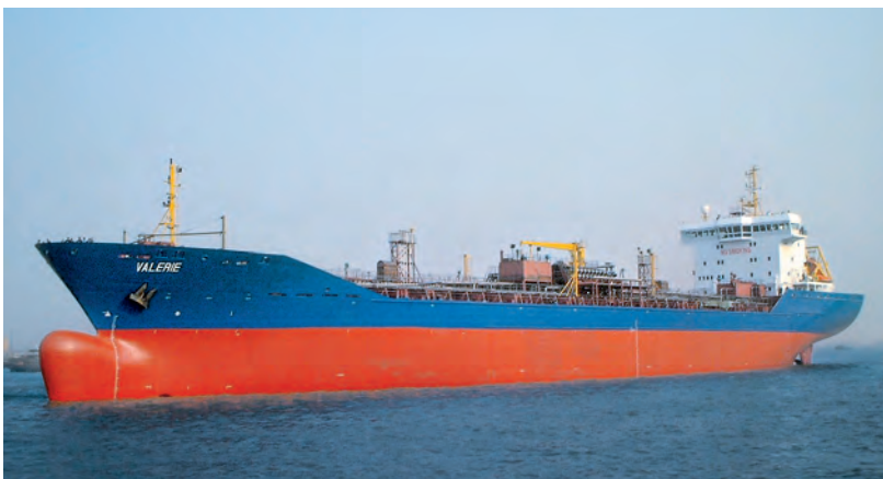
Chimiquier avec cuves en EN 1.4462 (2205) (Source : Aperam)
