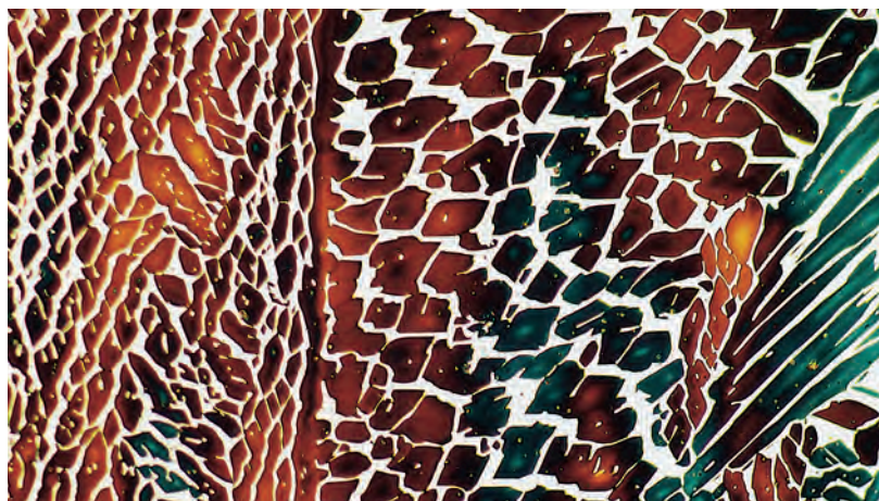
Structure métallographique du métal duplex EN 1.4462 (2205) déposé, 500x (Source : Lincoln Smitweld bv)
