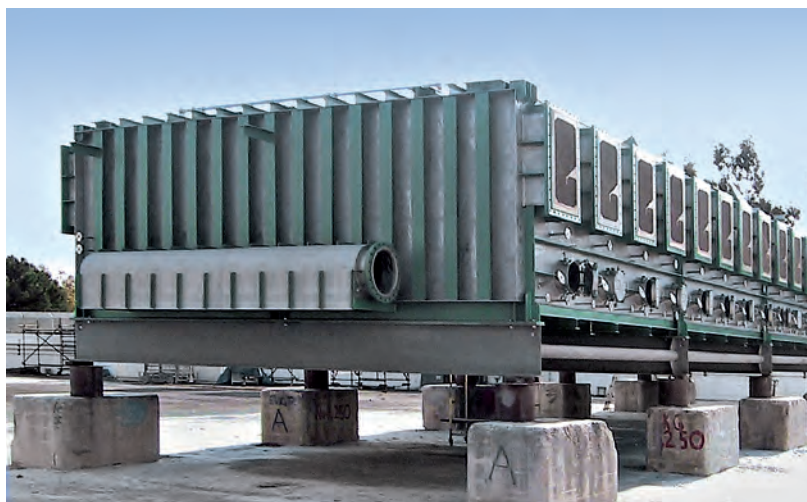
Elément d'une installation de dessalement d'eau de mer par distillation à détente étagée (MSF), aciers duplex EN 1.4162 (UNS S32101) et EN 1.4462 (2205) (Source : Outokumpu)
