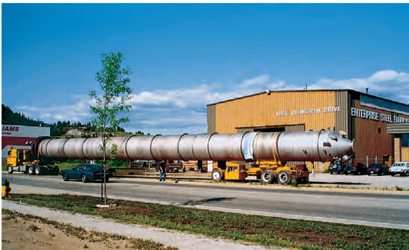
Réacteur de délignification à l'oxygène, en acier EN 1.4462 (2205), Entreprise Steel Fab, Kalowna, Prince George, Colombie Britannique, Canada (Source : Outokumpu)
