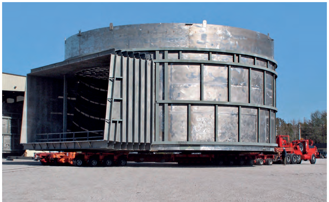
Élément d'une installation de désulfuration des fumées réalisé en acier inoxydable EN 1.4462 (2205) (Source : Aperam)
