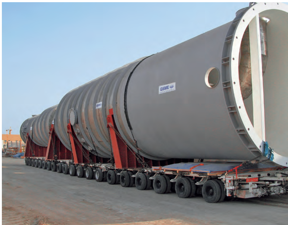
Evaporateur à film tombant, en acier inoxydable EN 1.4410 (2507) (Source : Gary Carinci, TMR Stainless)
