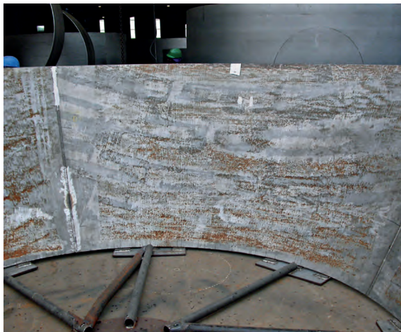
Fer incrusté dans une pièce profilée à partir d'une tôle d'acier duplex (Source : Gary Carinci, TMR Stainless)
