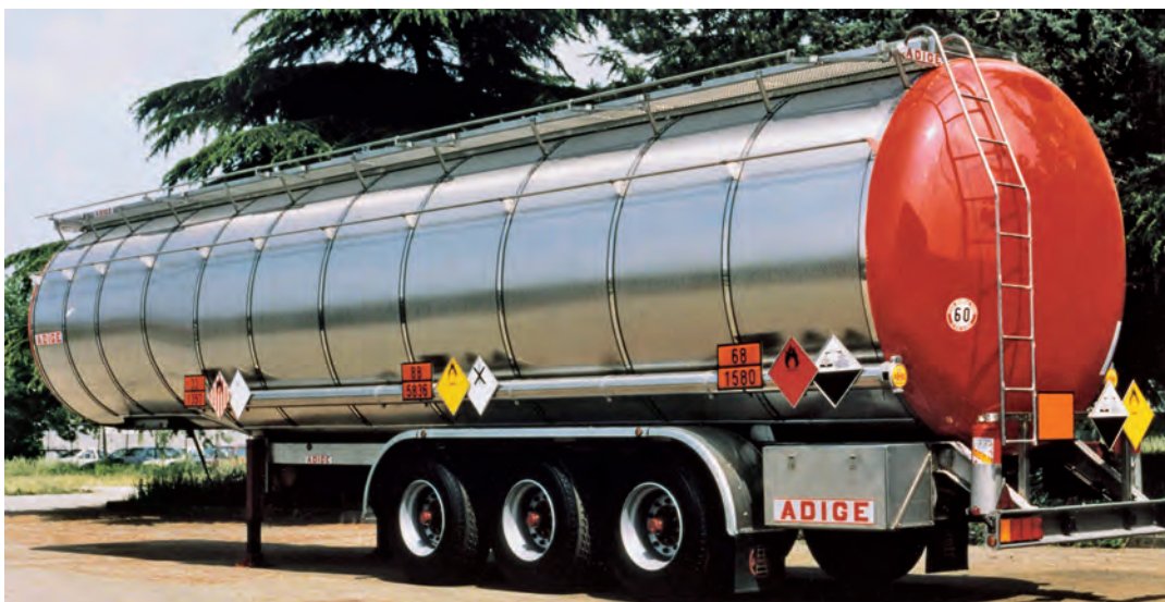
Serbatoio per l'autotrasporto di asfalto in lean duplex (Fonte: Outokumpu)
