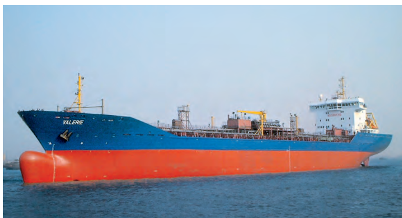
Chimichiera con serbatoi in EN 1.4462 (2205) (Fonte: Aperam)
