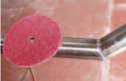
Angle préformé en biseau avec un seul raccord soudé.
