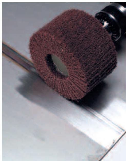
Exemple de brosse à lamelles en Scotch-Brite™. Ici la roue en Scotch-Brite™ brosse la zone ternie par la chaleur de soudage pour homogénéiser le joint soudé avec le métal environnant. Cette opération de finition ne vise pas à aplatir le joint ( ce qui exigerait une opération initiale de meulage ).
