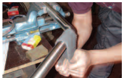
Finition manuelle homogénéisant l'ensemble du rail en une seule finition où les deux tubes ont un raccord lisse.
