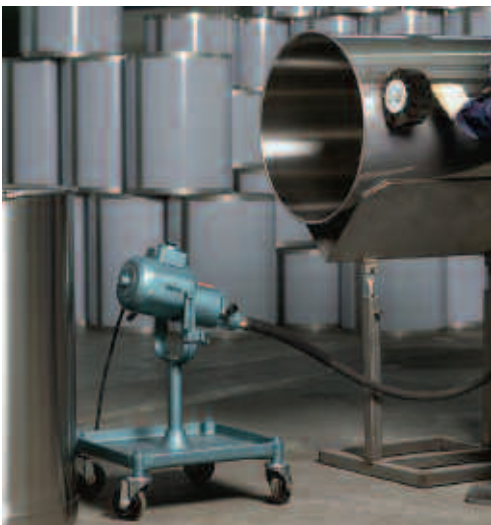
Les machines à arbre flexible ont en général un moteur électrique puissant fonctionnant en 380 V. Ceci permet d'utiliser diverses têtes de finition puissantes mais légères. L'utilisation d'unités très puissantes mais plus lourdes limite la portabilité de l'appareil.
