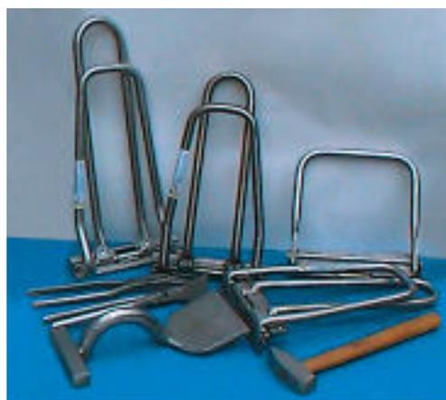
*I tetti di acciaio inossidabile possono essere costruiti con i normali attrezzi, a patto di evitare la contaminazione con particelle di acciaio al carbonio.*
