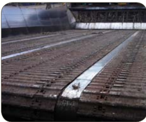
1.4003 (410), Columbus, Südafrika. Diese Anlage ist seit 22 Jahren in Betrieb.
