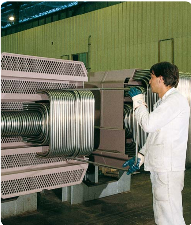
Wasserschleier/Zwischenbehälter aus 1.4510 (439), Europa.
