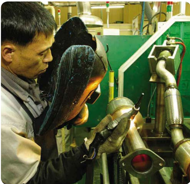
Geschweißtes Abgassystem aus 1.4510 [439], S. Korea.
