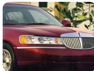
Kühlergrill und Zierleiste aus 1.4513 (438).
