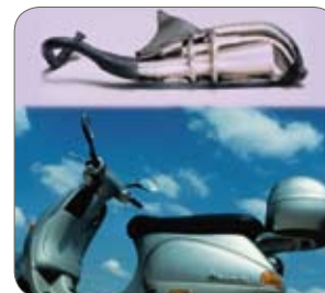
Nuance 1.4509/441, Centro Inox, Italie. La nouvelle Vespa ET2 est équipée d'un silencieux catalytique ferritique.
