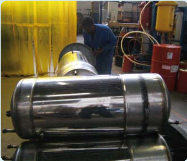
Réservoir soudé en nuance 441, Atrique du Sud.
