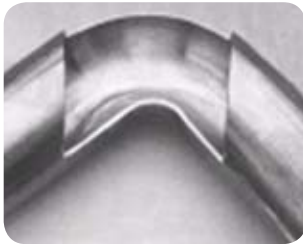
Cintrage d'un tube soudé en 430Ti.
