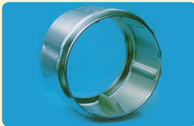
Tambour de sèche linge : tôle en 409 soudée, formée par expansion.
