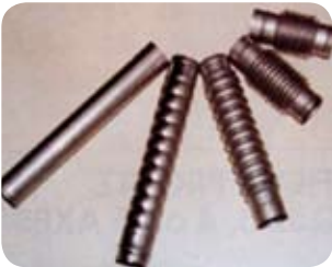
Cintrage d'un tube soudé en 430Ti.
