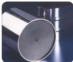
Tipo SUS 430J1L, guscio del convertitore catalitico, a nido d'ape in 20%Cr-5%Al
