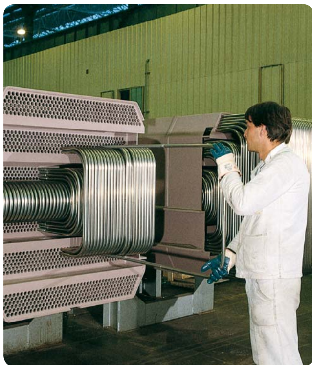
Separatore di umidità del riscaldatore, tipo 439, Europa.
