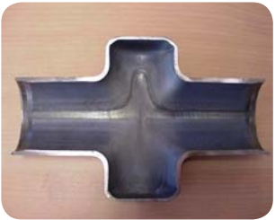
1.4003 tubo saldato idroformato.
