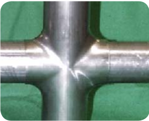
1.4003 tubo saldato idroformato.
