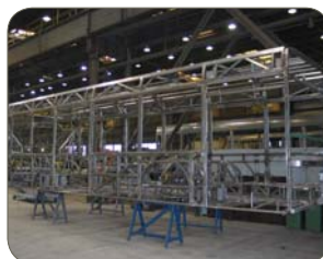
Tipo 1.4003, pannelli e tubi saldati, Solaris Bus and Coach Co., Polonia
