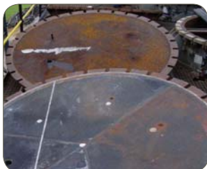
Tipo 1.4003/410, Columbus, Sud Africa. Acciaio al carbonio (in alto) paragonato all'acciaio ferritico (in basso) dopo 6 anni di servizio
